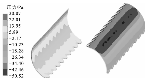
图15 多元耦合叶片表面压力云图
